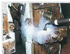
▲製造機器周辺の脱脂洗浄に
